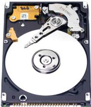
Durch ein Festplattenlaufwerk werden magnetische Informationsbits gespeichert, und zwar auf der Oberfläche von sich drehenden Scheiben im Inneren des Laufwerks. Präzise Lese- und Schreibköpfe, die an Aktuatoren (schwenkbaren Armen) befestigt sind, lesen die Informationen, während sich die Scheibe dreht. Dies ist in etwa mit der Funktionsweise eines Schallplattenspielers zu vergleichen.
